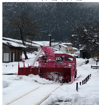
ロータリー除雪車除雪
